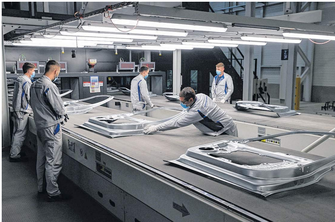
Mitarbeiter kontrollieren Türteile für den ID3 nach dem Verlassen der neuen XL-Pressen. Foto: Jan Woitas/dpa
